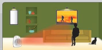
Distribution d'air chaud avec un soufflant classique
