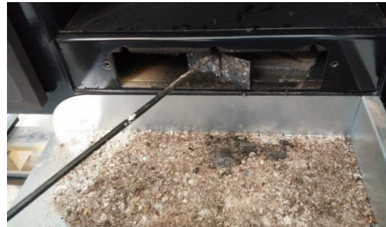
Figure n°13 - Accès pour le nettoyage de la sortie de fumée
