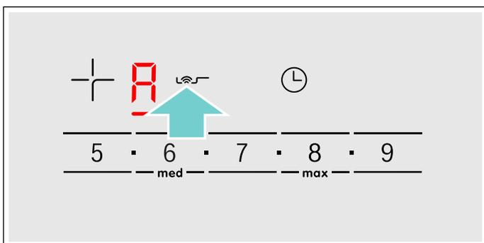
2. Dans les 10 secondes suivantes, sélectionnez le niveau de température souhaité dans la zone de réglage.
