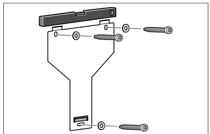
Serrez à la main la suspension pour la hotte, alignez-la horizontalement avec un niveau à bulle, puis vissez.
