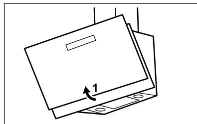
2. Нажмите на рукоятку фиксирующей защелки на панели фильтра под вытяжкой (1).
