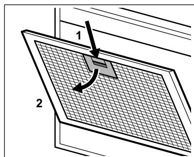
3. Bøy fronten på filteret forsiktig nedover (2), og trekk. Gjenta de to første trinnene for alle filtere.
