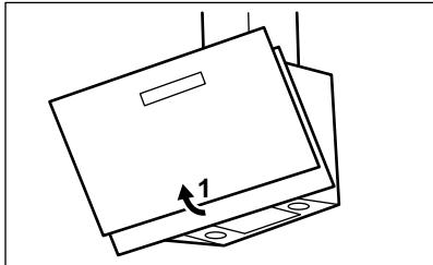
2. Πίεστε τη λαβή του κλιπ στερέωσης στο πλαίσιο του φίλτρου κάτω από τον απορροφητήρα (1).
