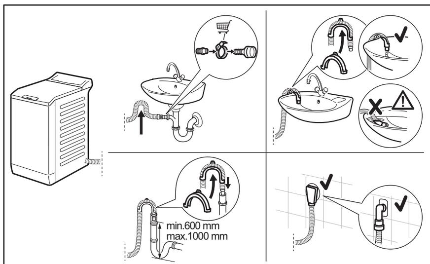
Le tuyau de vidange doit être installé à une hauteur du sol comprise entre 600 et 1 000 mm. La longueur maximale du tuyau de vidange est de 4000 mm. Contactez le service après-vente agréé pour obtenir d'autres longueurs de tuyaux de vidange et des rallonges.
